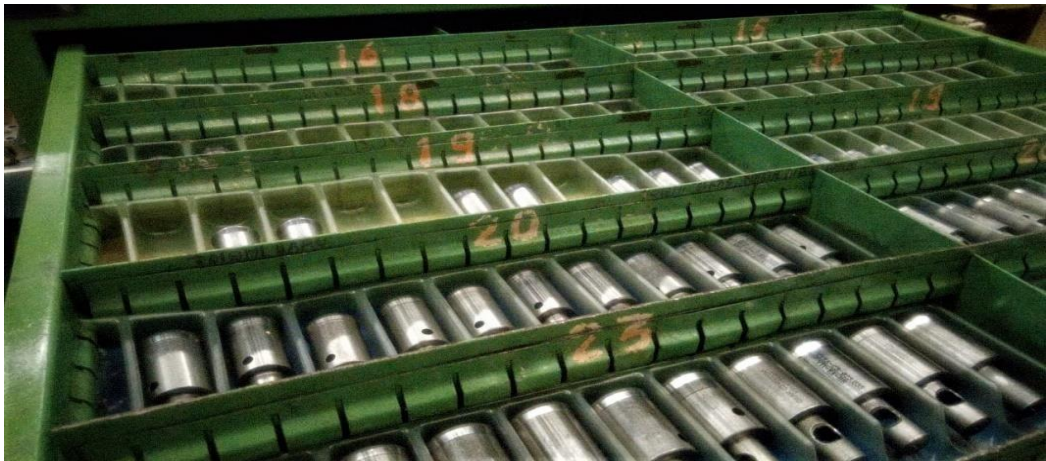
Gambar 4. 2 Perbaikan Penempatan Gauge
