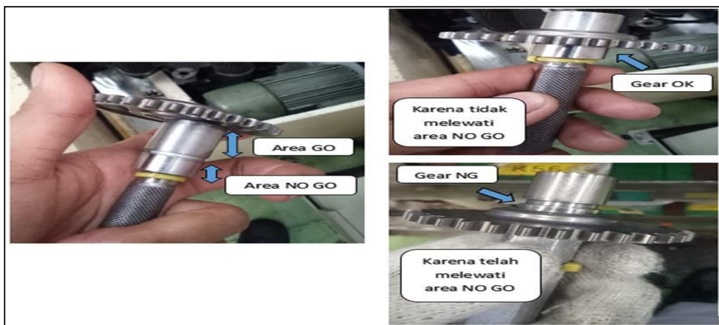
Gambar 3. 14 Cek Dimensi Dengan Plug
